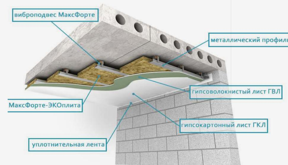
Каркасный потолок «Базовый» 30м
